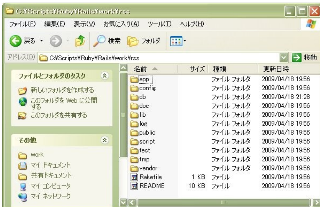
図: Railsのrssアプリケーションのインストールディレクトリ
